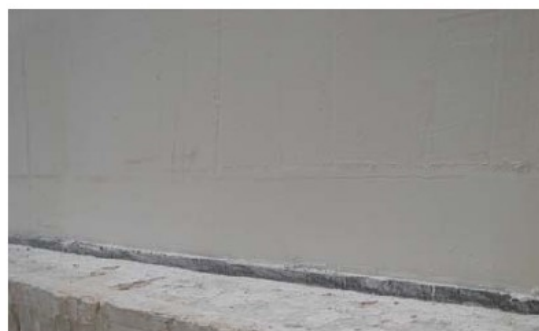
Foto 5: Detalle de unión inferior fábrica-marco portamuestras
