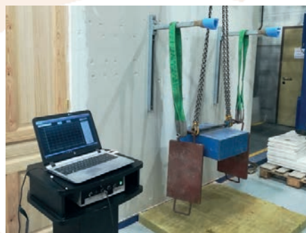
Ensayo de resistencia a daños estructurales por cargas verticales excéntricas. Estantería con una carga a 30cm, aplicando 1000N continuamente durante 24h.
