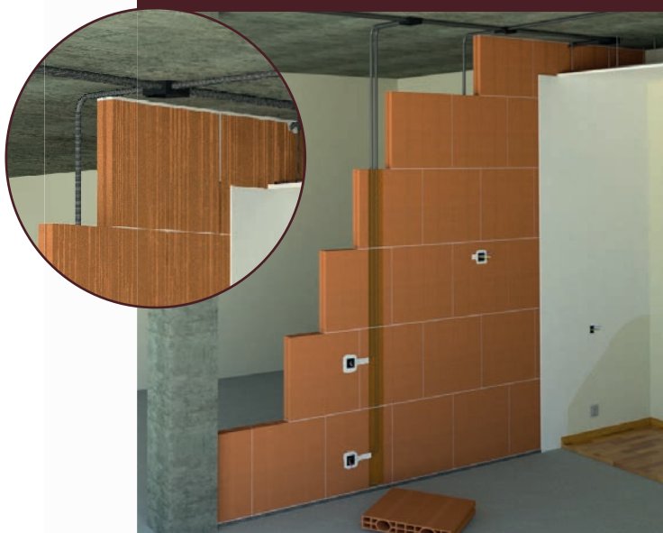
Paso de las instalaciones por el falso techo
